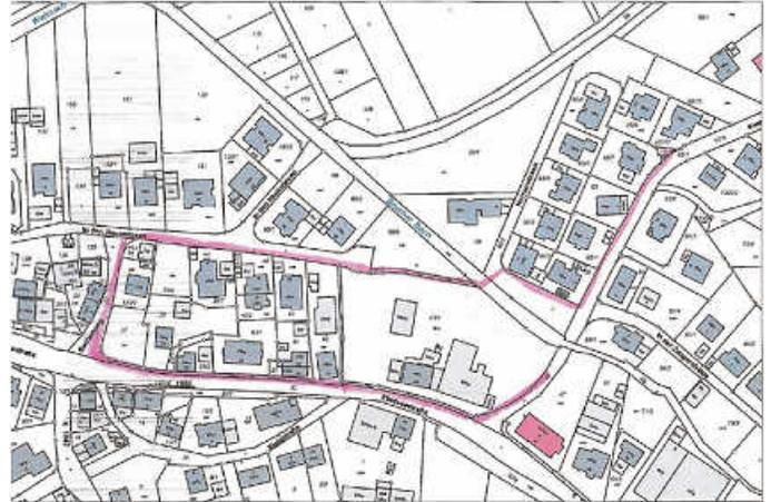
Begonnen wird ab der Trafostation Kammerhofweg Nr. 13 entlang des Kammerhofweges bis in die Herrenwiesen. Mittels einer Spülbohrung unter der Fußgängerbrücke hindurch in die Straße In den Hauswiesen, über den Eschenweg in die Ebniseestraße zur bereits vorhandenen Trafostation und zurück zur Kammerhofbrücke entlang der Ebniseestraße.
