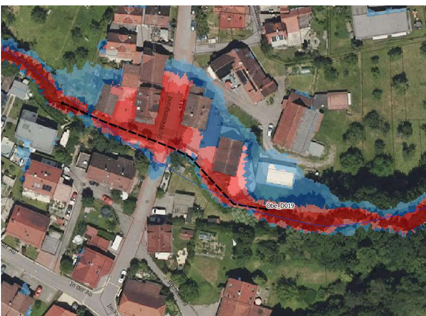
Abb. 15 Überflutung Verdolung Brucher Bach (außergewöhnliches Ereignis, Bildquelle © LGL)
