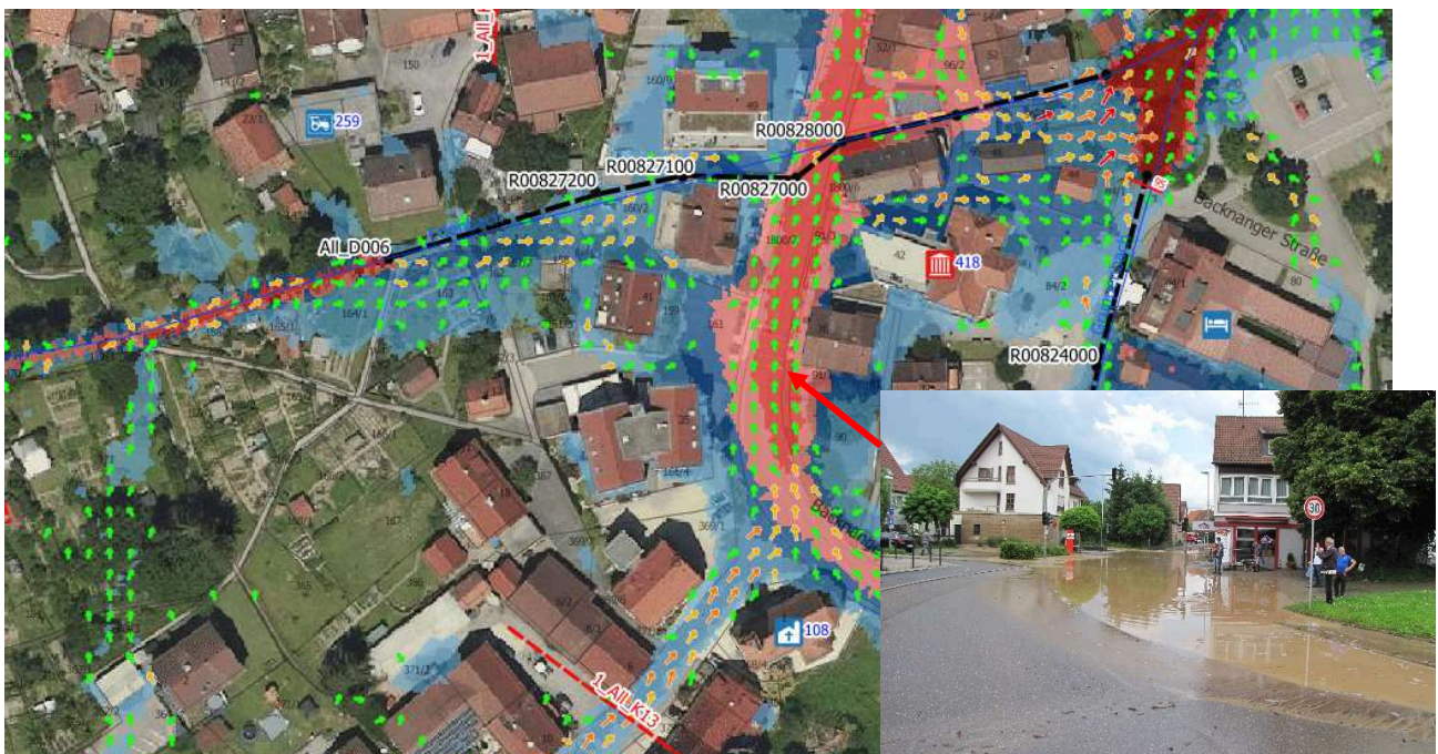
Abb. 7 Überflutung Ortskern Allmersbach (außergewöhnliches Ereignis, Bildquelle © LGL, AG)
